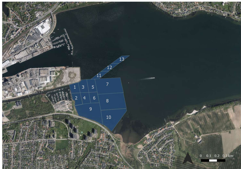
Figur 4-1: Oversigtskort over området for uddybning til Marina City. Uddybningsområdet er mar- keret med blå rektangler. I område 7-10 uddybes reelt kun i den vestlige rand.
